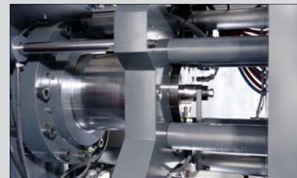
Adaptación opcional de la altura de montaje del molde mediante cambio sencillo del bulón de apriete
