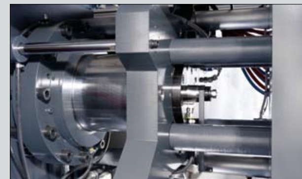
Modifica (opzionale) dell'altezza di montaggio stampo grazie alla sostituzione dei distanziali tra pistone di chiusura e piano mobile
