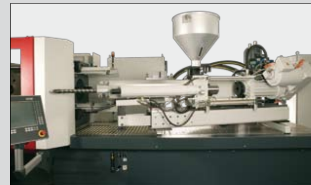
Unità d'iniezione pivotante per manutenzione facilitata
