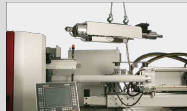
Cambio rapido vite e cilindro per adattare la macchina a nuove produzioni
