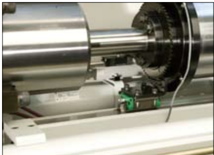
Il supporto del pistone d'iniezione rotante garantisce la più elevata guida e l'esatta rotazione della vite
