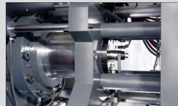
Adaptation optionnelle de la hauteur du moule par simple échange de colonnettes
