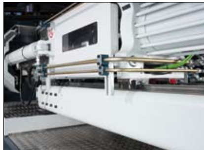
L'unité d'injection dispose en standard des supports supplémentaires sous le cylindre de plastification pour augmenter la rigidité
