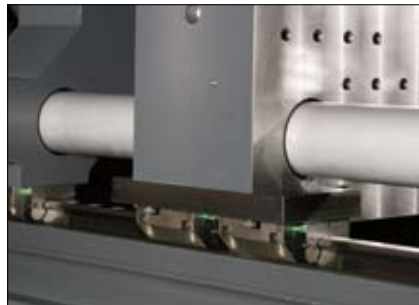
Les rails de guidage du plateau mobile garantissent un guidage précis des moules, même les plus lourds
