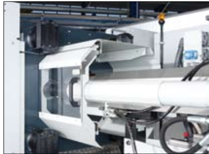
Die Teilverkleidung der Spritzeinheit sorgt für optimale Zugänglichkeit
