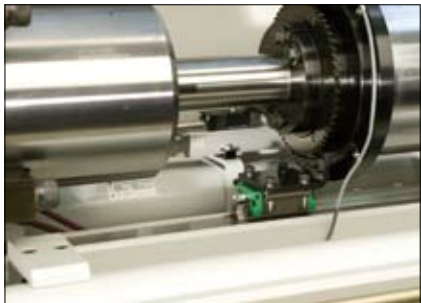
Die Abstützung des drehenden Spritzkolbens gewährleistet die hochpräzise Führung und den exakten Rundlauf der Schnecke
