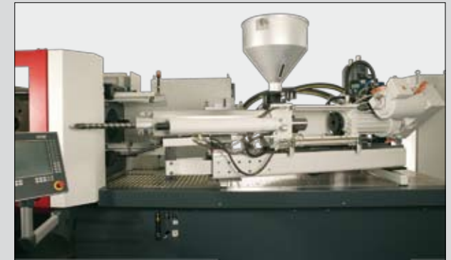
Ausschwenkbare Spritzeinheit für einfache Wartung
