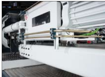
Der Aufbau der Spritzeinheit mit Plastifizierzylinder-Abstützung ist besonders robust
