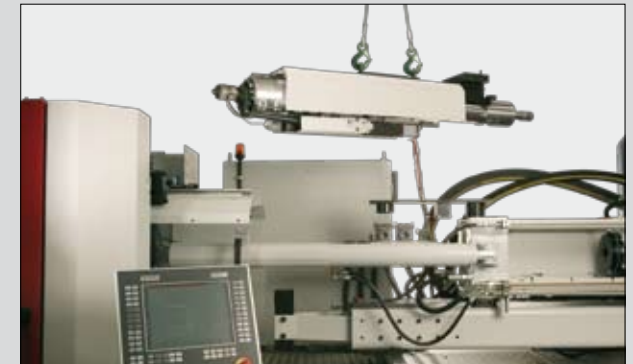
Schneller Schnecken- und Zylinderaustausch für neue Produktionsaufgaben
