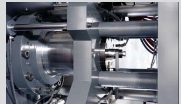
Optionale Anpassung der Werkzeugeinbauhöhe durch einfachen Austausch der Druckbolzen
