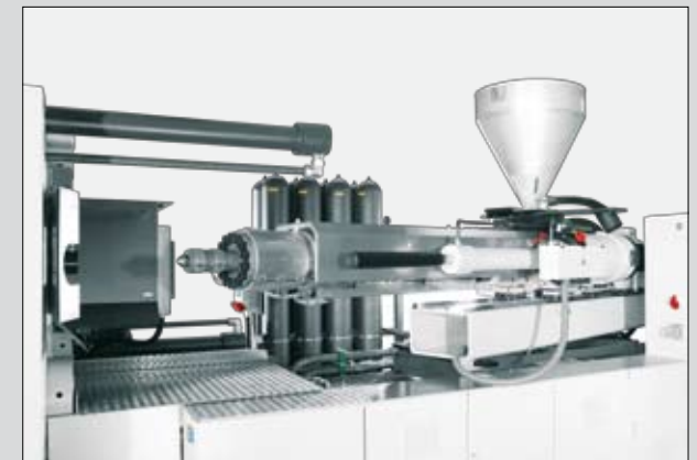
L'unità di iniezione completa e' pivotante liberamente verso l'esterno
