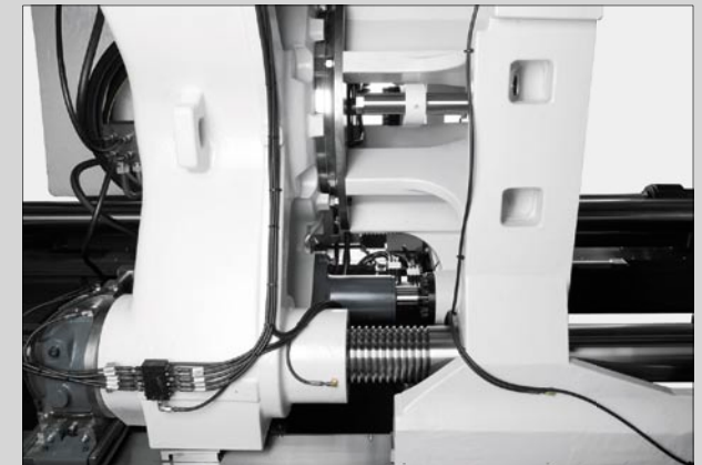
Positionieren der Werkzeugeinbauhöhe mit wartungsarmen Führungsbuchsen und Fettzentralschmierung für die Schließseinheit
