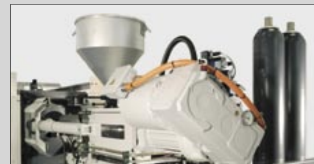
Entraînement électrique en option de la vis à injection pour plastification parallèle
