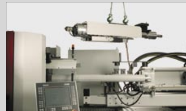
Changement rapide de la vis d'injection et du cylindre pour une nouvelle production
