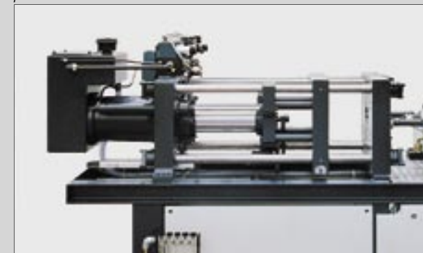
Adaptation optionnelle de la hauteur du moule par simple échange de boulons
