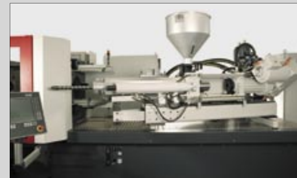
Unité d'injection pivotante pour une maintenance simplifiée
